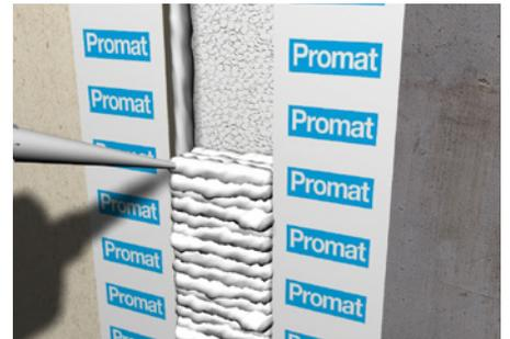
6. Aplique el espesor correcto de sellante (acorde a los requisitos del ensayo).
