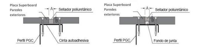
Aplicación: instale cinta de enmascarar a los bordes de las placas, con el objeto de delimitar la junta, instale el cordón de fondo y aplique el sellador poliuretánico, verificando que este llene la totalidad de la junta. Rehundir con espátula en el caso que sea necesario
