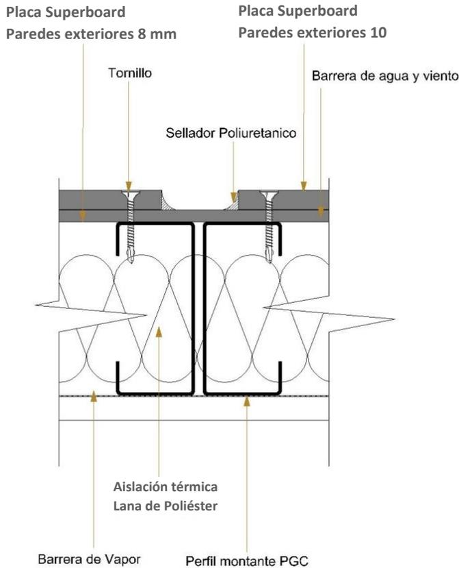
Las placas Superboard paredes exteriores Durlock® colocadas en el exterior deberán poseer algún tipo de terminación (pinturas plásticas para exteriores, revoque plástico o revestimientos) que conforme su sellado hidrófugo.
