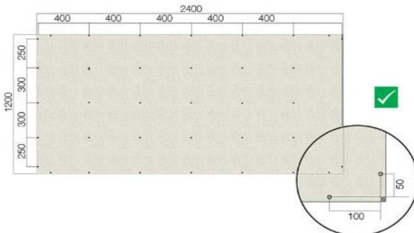
8. Las juntas entre placas deberán coincidir con un montante (en vertical) y soleras o flejes en horizontal para garantizar el fondo de junta.
