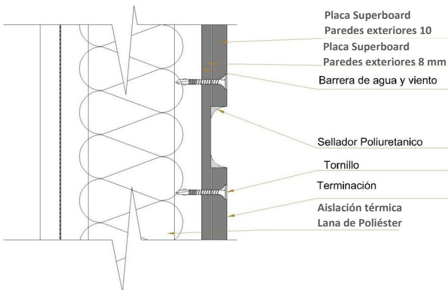
5.2.2. DETALLE SISTEMA DE CERRAMIENTOS JUNTA VISTA-DOBLE PLACA-REMATE
