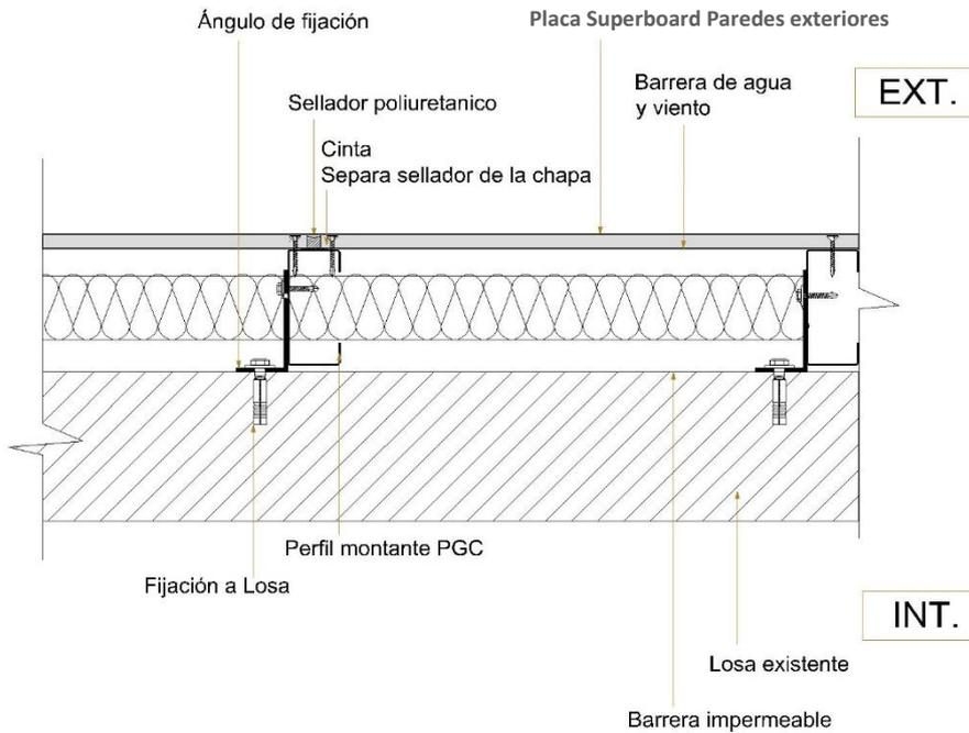
5.1.3. DETALLE PLANTA CERRAMIENTO ENTRE VIGAS JUNTA VISTA
