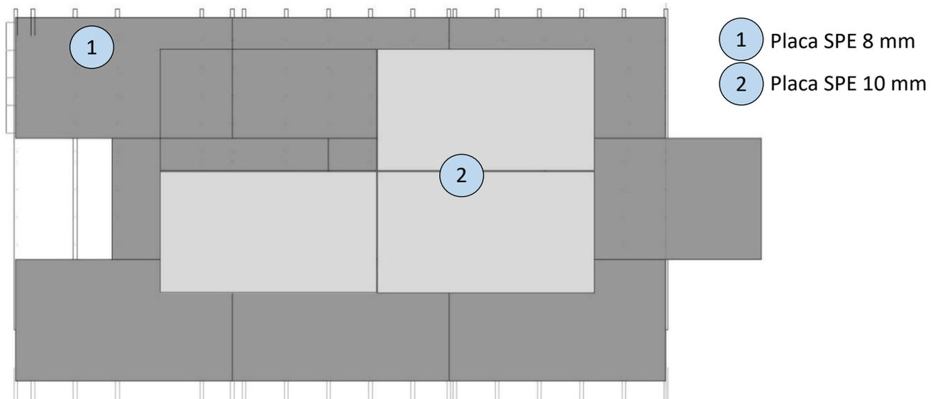
9. Irán fijadas con tornillos compatibles con la estructura de soporte. En el caso de estructura de acero galvanizado se utilizará tornillos autoperforantes, autofresantes, puntamecha con alas. En el caso de estructura de madera serán tornillos tipo drywall con rosca para madera, se deberá realizar previamente el fresado de las placas.
