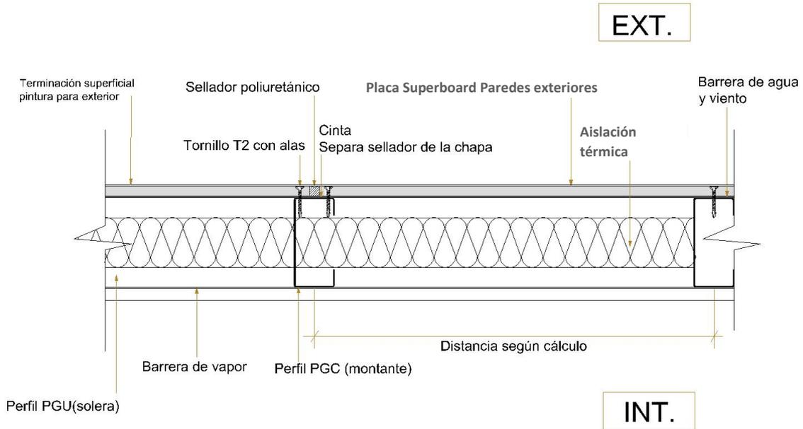
5.1.4. CORTE VERTICAL SISTEMA DE CERRAMIENTOS JUNTA VISTA
