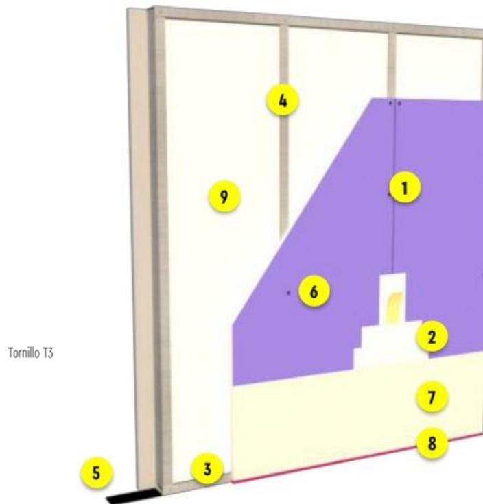
Pared interior compuesta por una estructura metálica sobre la cual se atornilla una capa de placas Durlock® Cuatro Dimensiones por cara. Dentro de la cámara interior de 70mm se podrá colocar lana de poliéster
