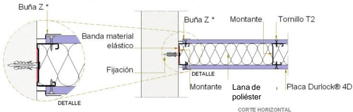
\* El perfil Buña Z podrá fijarse con tornillos T2 colocados con una separación de 15cm o con adhesivo de contacto. Luego recibirá dos manos de masilla Durlock®.
