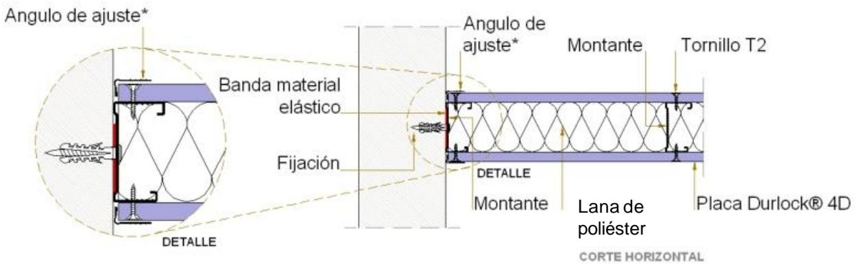
\* El perfil Angulo de ajuste podrá fijarse con tornillos T2 colocados con una separación de 15cm o con adhesivo de contacto. Luego recibirá dos manos de masilla Durlock®.
