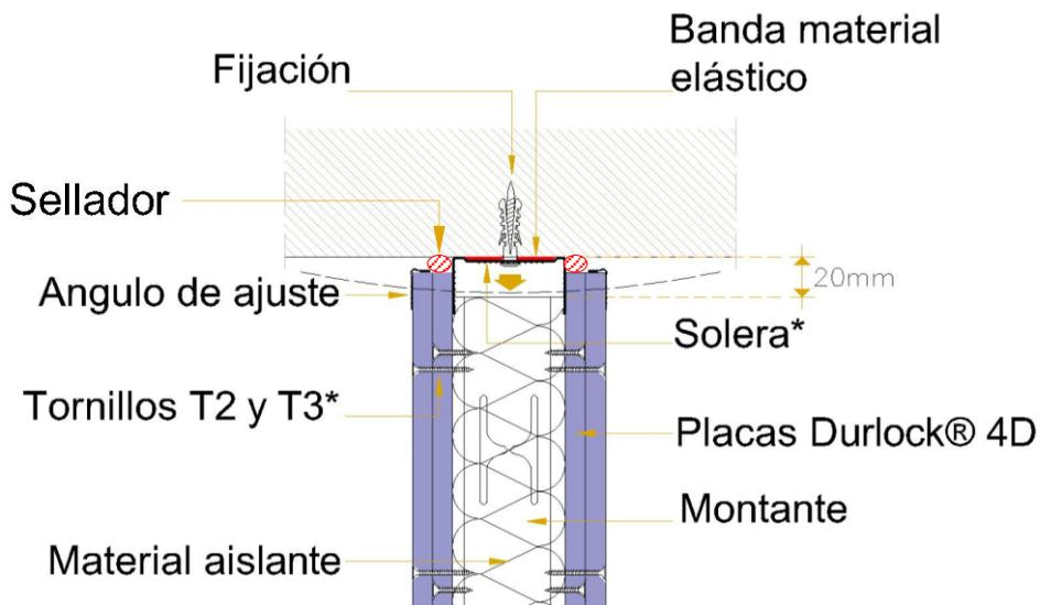
(\*) La solera superior no debe atornillarse a los perfiles Montante.
