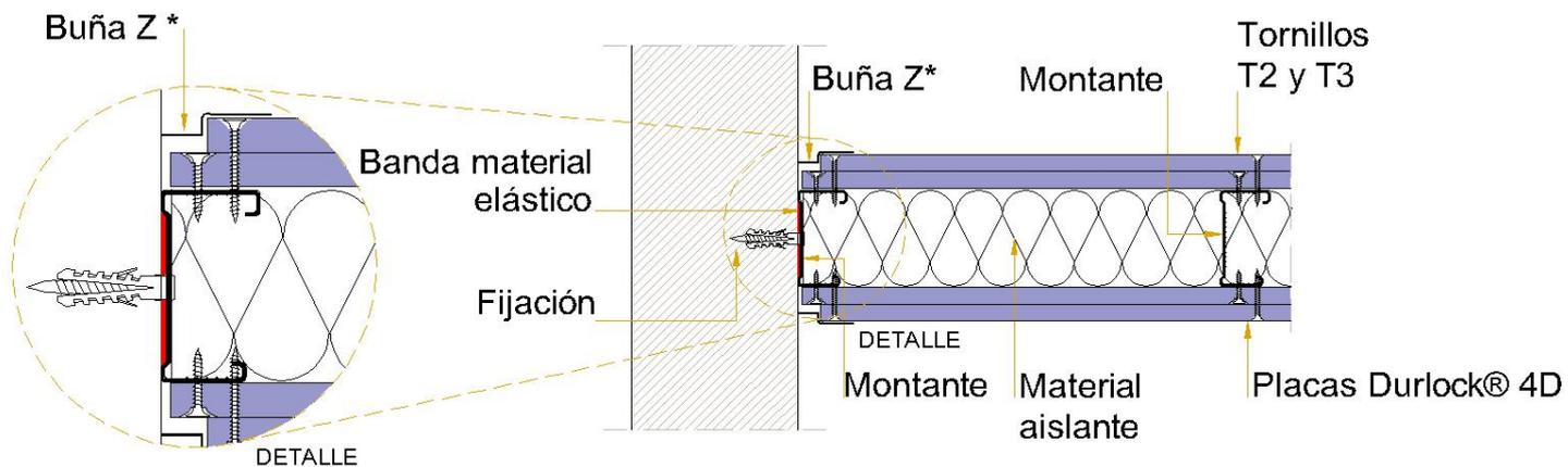
(\*) El perfil ángulo de ajuste y buña Z podrán fijarse con tornillos T2 colocados con una separación de 15cm. o con adhesivo de doble contacto. Luego recibirá dos manos de masilla Durlock®. En caso de utilizar placas de 15mm. de espesor, el tornillo T3 se reemplazará por tornillos T4.
