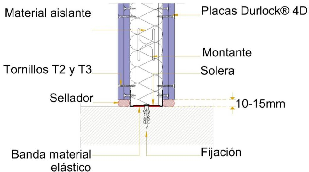
**Fijación de solera inferior. Ambientes húmedos. Solución banda + Sellador Hidrofugo.**
