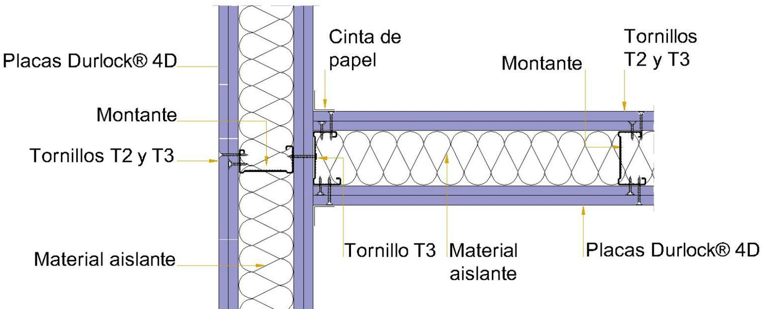
(\*) El perfil Cantonera podrá fijarse con tornillos T2 colocados con una separación de 15cm. o con adhesivo de doble contacto. Luego recibirá dos manos de masilla Durlock®.
