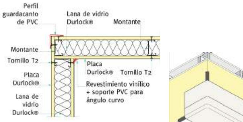
Para materializar rincones curvos, se coloca un accesorio de PVC con adhesivo de doble contacto. El revestimiento vinílico se instala con soldadura de las juntas por termofusión, lo que minimiza el riesgo de filtraciones o acumulación de bacterias.
