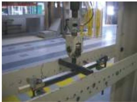
ENSAYO DE FLEXIÓN, MONTANTE DE 34MM
