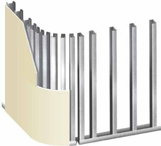
Utilizando las Soleras como guía, se colocarán los Montantes con una separación determinada en función del radio de curvatura de la pared, según la siguiente tabla.
