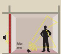
**Índice de reducción acústica (R):** El aislamiento acústico de un elemento indica su capacidad de oposición a la transmisión del ruido aéreo. Los procedimientos para obtenerlo definen una curva de aislamiento en función de la frecuencia del ruido, debido a que la capacidad aislante del elemento varía con ella.
