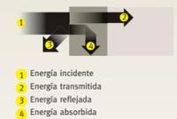
La propagación del ruido se puede controlar por aislamiento y por absorción del sonido, dos fenómenos distintos que obedecen a leyes dispares y exigen la utilización de materiales de diferentes características.
